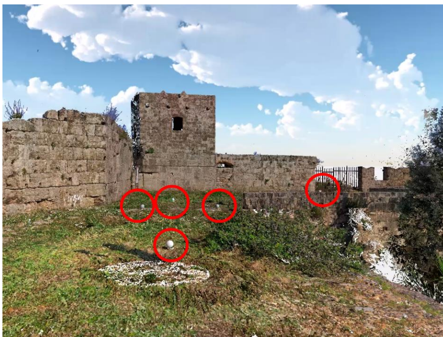
Εικόνα 10. Ανακλαστικές σφαίρες όπως αποτυπώθηκαν σε μια 3Δ αποτύπωση με επίγειο σαρωτή (σημειώνονται με κόκκινο κύκλο).
